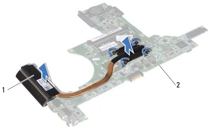
1 conjunto do dissipador de calor
